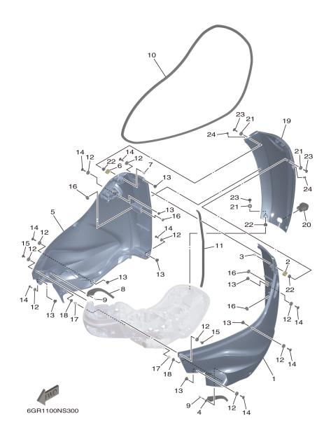
FIG. 29 BOTTOM COWLING 2
