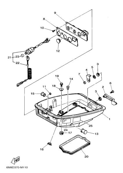
FIG. 11 BOTTOM COWLING
